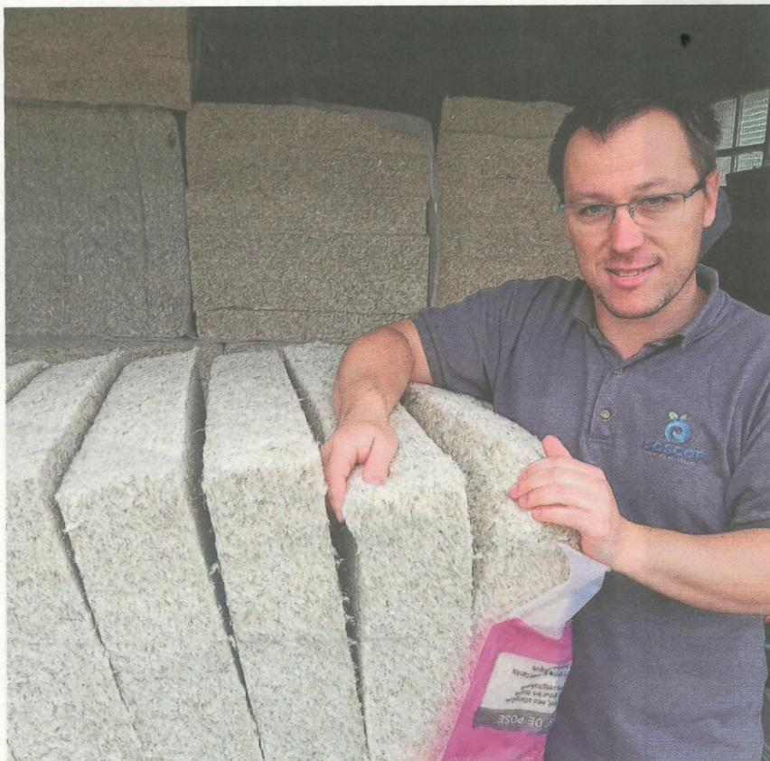
Yann Fromager, gérant d'Isoscop, montre les panneaux de chanvre qui sont utilisés pour l'isolation par le toit d'une maison. (Photo NR)
